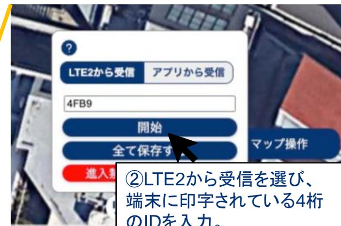
②LTE2から受信を選び、端末に印字されている4桁のIDを入力。開始をクリック、
