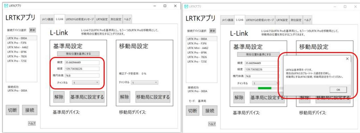
「基準局設定する」ボタンを押して1分ほど待つと設定が完了し、成功メッセージが表示されます。
